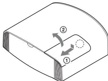
**4** Desserrez la vis du couvercle de la lampe (couvercle intérieur) avec un tournevis cruciforme, puis ouvrez le couvercle de lampe.
