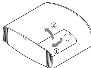
**4** Ослабьте винт дверцы лампы (внутренняя крышка) крестообразной отверткой, затем откройте дверцу лампы.
