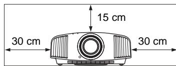
Aufgrund des Luftstroms von Klimaanlagen oder den Lüftungsöffnungen dieses Geräts oder anderer Geräte kann es auf der Leinwand zu Schwankungen kommen. Achten Sie darauf, dieses Gerät so aufzustellen, dass der Luftstrom von Klimaanlagen oder den Lüftungsöffnungen der Geräte die Vorderseite dieses Geräts nicht erreicht.
